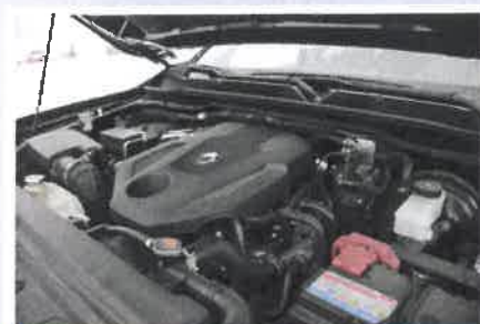
Le 4-cylindres diesel 2,3 litres de 190 ch est assez bien insonorisé.
